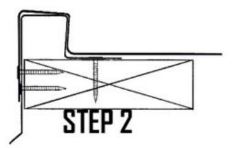
LAY ROOFING MEMBRANE OVER THE CANT DAM SO THAT THE MEMBRANE IS AT LEAST 3" OVER FACE OF THE CANT DAM
